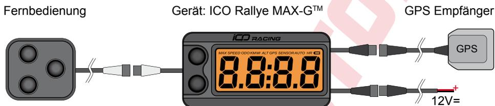
Der Rallye MAX-G™ wird über eine externe Spannungsversorgung 12V DC versorgt. (Rot = +12V, Schwarz = Masse, empfohlene Absicherung: 1A). Es ist unbedingt darauf zu achten, dass die Stromversorgung stabil ist!
